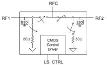
SPDT UltraCMOS<sup>™</sup> RF Switch DC - 7500 MHz
